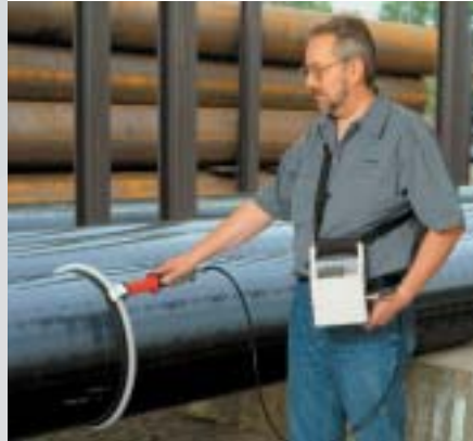
Porenprüfung an Pipelines
