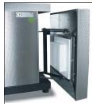
Parallel geführte Tür für dauerhaften Schutz der Kragenisolierung gegen Zerstörung beim Schließen der Tür
