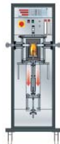
Heizkammer aus Molybdän/Wolfram
