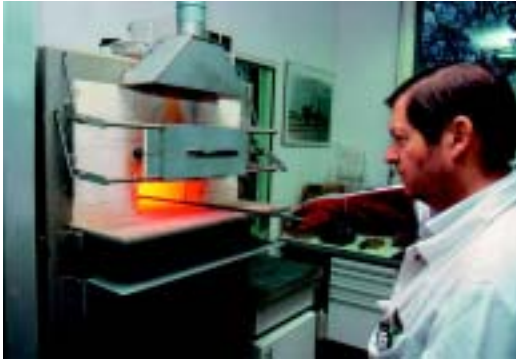
N 110/HS1 mit Hubtür für Goldschmelzversuche
