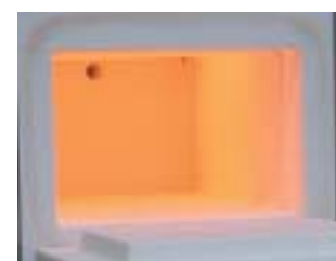
keramische Muffel mit Rundumbeheizung
