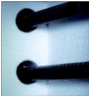
Ofenraum mit hochwertigem Fasermaterial und SiC-Heizstäben in den Ofenseiten
