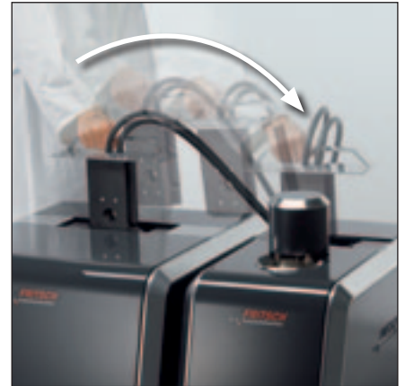
Bestens durchdacht: einfaches Parken der Messzelle in der Dispergiereinheit
