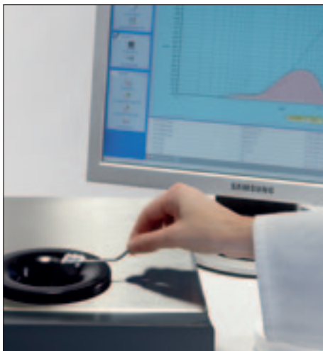
Einfaches Einfüllen der Probe in das Ultraschallbad der Nass-Dispersiereinheit
