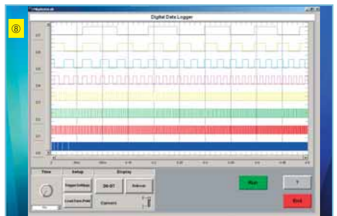
Windows-Software MEphisto Lab Instrumenten-Panel: ① Digital Speicher-Oszilloskop, Betriebsart „Zeit“. ② Digital Speicher-Oszilloskop, Betriebsart „XY“. ③ Spektrum-Analysator. ④ Datenlogger analog. ⑤ Voltmeter. ⑥ Logik-Analysator. ⑦ Digital-Switchbox. ⑧ Datenlogger digital.
