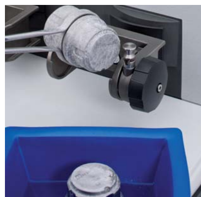
Die Mahlbecher werden vor der Vermahlung im Kryokit für ca. 2 - 3 Minuten in flüssigen Stickstoff (-196 °C) getaucht
