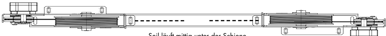
Seil läuft mittig unter der Schiene
