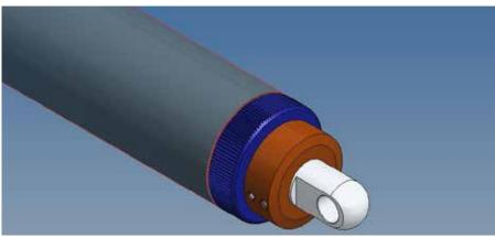
Verstellsicherung für DIREKT II mit Winkelgelenken (für steigende Bänder) Beim DIREKT II mit Winkelgelenken kann die Verstellsicherung nicht einfach aufgeschoben werden. Daher ist die Verstellsicherung für den DIREKT II mit Winkelgelenken zweiteilig und kann von beiden Seiten aufgesteckt werden. Beide Hälften werden miteinander verschraubt und zusätzlich noch mit einer Schraube gesichert.
