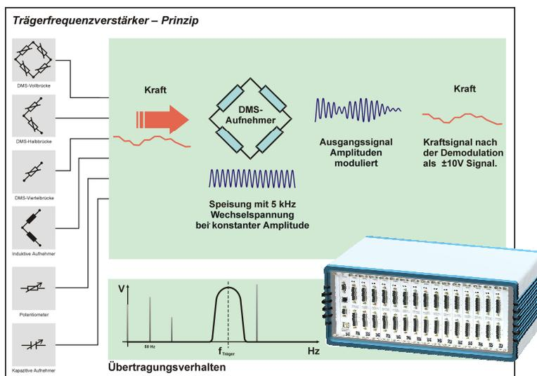
Der großen Vorteile der TF-Technik: Nur das Trägersignal +/- die Bandbreite wird übertragen. Störsignale wie Thermospannungen, Netzfrequenzen oder Einkopplungen liegen außerhalb des Übertragungsbandes.
