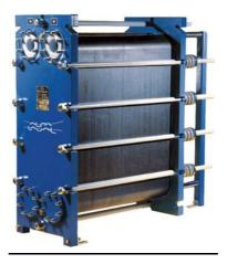
Der Wärmeübertrager verbindet die bekannten Vorteile eines Plattenwärmeübertrager mit den hervorragenden Korrosionseigenschaften der Werkstoffe DIABON F100 (Fluorkunststoff gebundenes Graphit) und DIABON NS1+ NS2 (Kunstharz gebundenes graphite)
