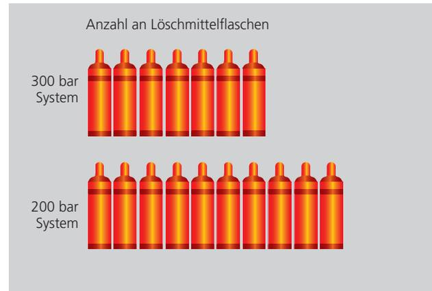
Durch den Einsatz des 300 bar Argonite-Systems kann die Anzahl der Löschmittelbehälter um 30% reduziert werden. Dadurch wird Platz geschaffen für eine alternative Nutzung oder eine Einsparung von Baunebenkosten. Weniger Flaschen bedeuten auch geringere Kosten für Transport, Montage, Wartung und nach einem Löscheinsatz einen geringeren Montageaufwand beim Flaschenwechsel. Schnell und kostengünstig ist die Löschanlage wieder betriebsbereit.
