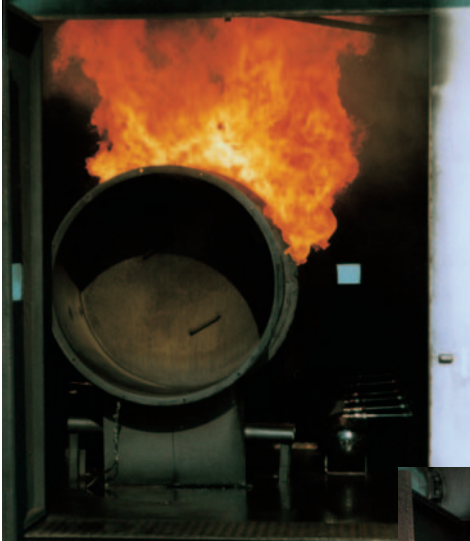
Brandversuch: Vollbrand einer mit Diesel getränkten Isolierung
