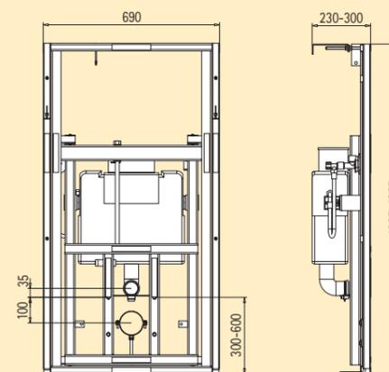
Der Vorwandrahmen mit vormontiertem Spülkasten ist zur Aufnahme in handelsübliche Vorwandinstallationssysteme geeignet.
