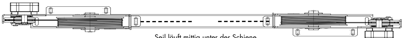
Seil läuft mittig unter der Schiene
