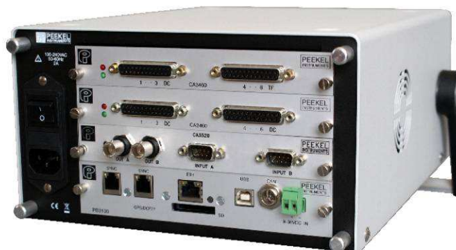
Ein Blick auf die Rückseite von PICAS-Touch zeigt den Einschub PB3100 mit seinen Anschlussmöglichkeiten.
