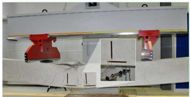
Druckversuch an einem Betonbalken, dokumentiert mit PICAS-Touch. (Quelle: Baustofflabor an der Universität Siegen)
