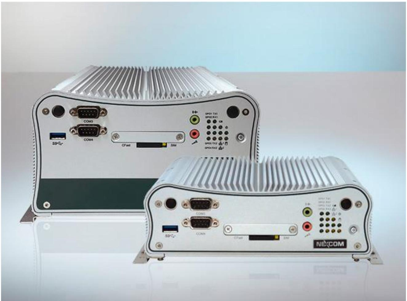
**Spectra NISE 2400-Serie: Flexibel konfigurierbare Mini-PCs für den industriellen Einsatz auf Grundlage von Intel® Atom™ Bay-Trail-Prozessoren (E3827 Dual Core und E3845 Quad Core)**
