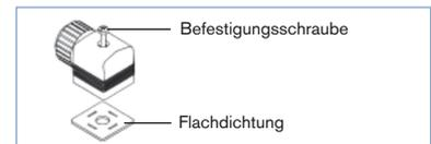
Zum Lieferumfang einer Gerätesteckdose gehören Flachdichtung und Befestigungsschraube. Weitere Ausführungen an beschalteten Gerätesteckdosen nach DIN EN 175301-803 A (bisher DIN 43650) siehe Datenblatt Typ 2508
