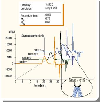
Bei der GPC mit RI- und/oder UV-Detektion ist ein präzises Injektionsvolumen wichtig, elementar ist es bei gekoppelten Systemen mit Lichtstreu-, Triple- oder Viskositäts-Detektion. Der SECcurity Probengeber liefert höchste Präzision (<0,5% RSD) und überlegene Genauigkeit. Vorteilhaft sind auch die schnellen Zykluszeiten und das einzigartige Durchflussprinzip das gerade bei HighSpeed-Analysen erste Wahl darstellt.
