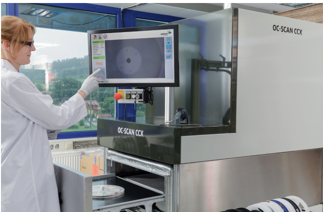
Gegenwart: Berührungslos, automatisch und exakt Bauelemente zählen.
