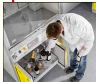
Gebinde können mit beiden Händen eingestellt und entnommen werden. Im Brandfall wird über Thermoelement automatisch die Schließung der Türen eingeleitet.
