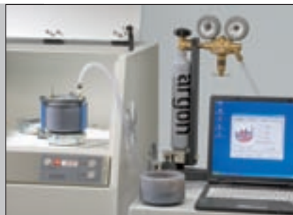
Die PULVERISETTE 4 beim Mahlen unter Schutzgas
