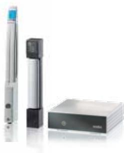
Schränke entwickelt, dessen Ziel die berechnete Freigabe einer Schranktür durch einen elektronischen Verschluss ist. Das Produkt besteht aus dem Griff mit einer RFID-Antenne und der Steuerelektronik, dem Subterminal B-Net 91 06. Die Identifizierung des Mitarbeiters erfolgt durch das RFID-Medium Legic. Jetzt ist es erstmals möglich, auch EDV-Schränke in Ihr bestehendes oder geplantes Zutrittskontrollsystem online zu integrieren.
