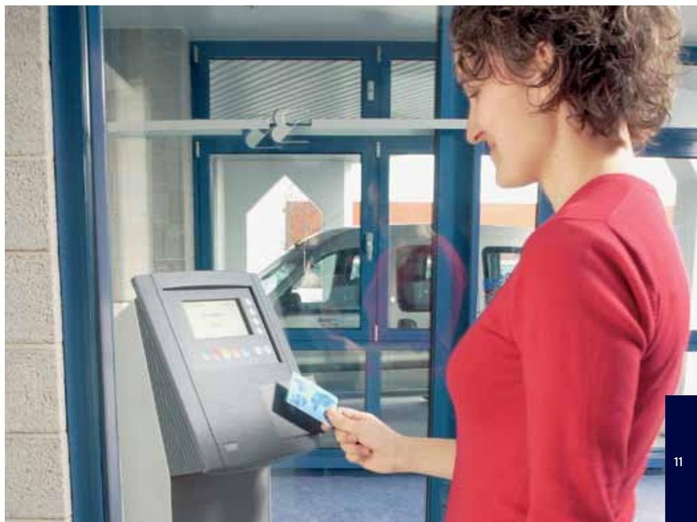
Im Falle eines Stromausfalls werden durch eine Batterie die Daten gespeichert sowie die Funktionalität des Terminals erhalten. Ist eine ausreichende Spannungsversorgung wieder gewährleistet, wird das Terminal automatisch wieder in den Betriebszustand versetzt. Um solche Störungen generell zu vermeiden, bieten wir Ihnen optional eine unterbrechungsfreie Stromversorgung an.
