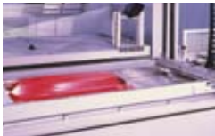
Die Thermokamera MP150 ermöglicht die detaillierte Darstellung der Temperaturverteilung an Kunststoffteilen während des Thermoformprozesses.
