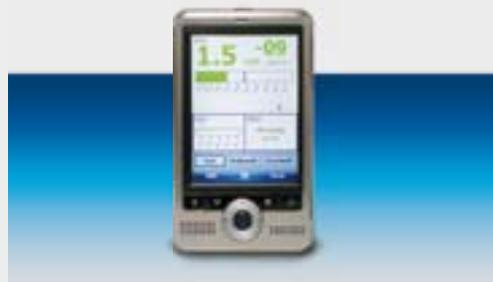
**ASM Pocket** - Das Softwarepaket für die drahtlose Fernsteuerung des Lecksuchers über PDA oder Smartphone. Die Messdaten werden am mobilen Endgerät angezeigt und gespeichert.
