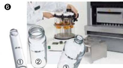
6 Das flexible Dichtsystem des Multivapors erlaubt es, alle Auffanggläser (60, 120, 220 und 240 ml) individuell abzudichten. Kreuzkontaminationen sind daher ausgeschlossen.
