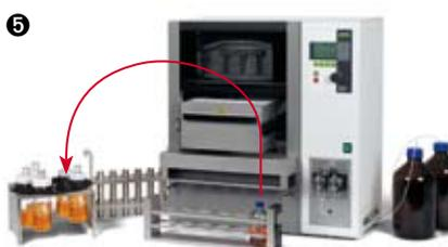
5 Die Auffanggläser können direkt – d. h. ohne Probentransfer – in den Parallelverdampfer Multivapor P-6 eingesetzt werden.
