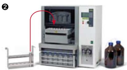
2 Der Heizblock kann einfach herausgezogen und die Extraktionszellen mit der Entnahmezange eingesetzt werden.
