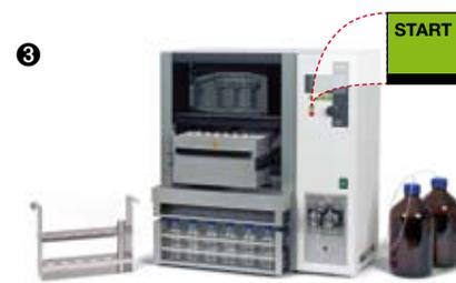
3 Das Schutzschild wird geschlossen, die Zellen automatisch verschlossen und per Knopfdruck werden 6 Proben extrahiert.
