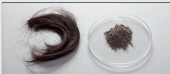
Haarprobe vor und nach der Mahlung mit der FRITSCH PULVERISETTE 23
