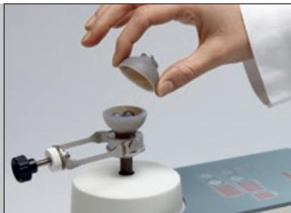
Praktisch und effektiv: kugelförmige Mahlbecher zum einfachen Zusammenstecken
