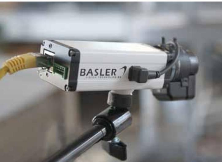
Ein ultrakompaktes Ganzmetallgehäuse mit einer Größe von 89,8 mm x 29 mm x 44 mm und einem Gewicht von nur 230 Gramm macht die Kameras zu den kleinsten IP-Kameras in ihrer Klasse.
