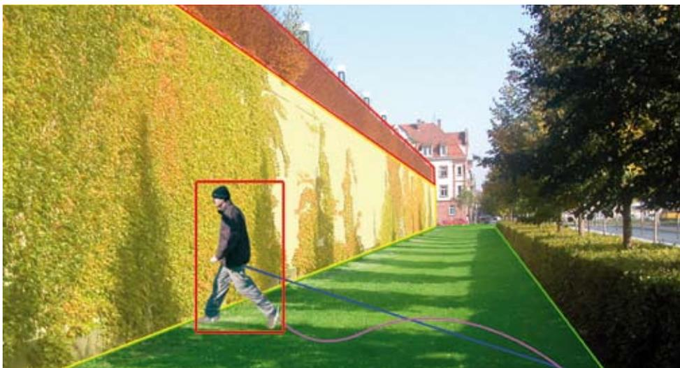
Bewegungsprofile: Darstellung von aktueller Objektgröße und -position sowie des zurückgelegten Weges
