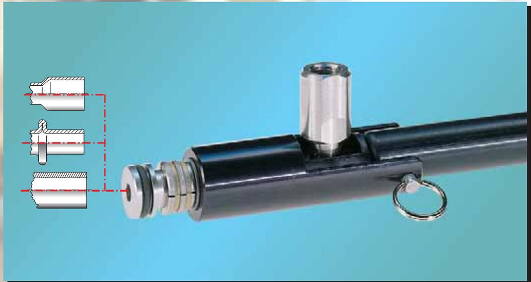
Patentierter Schnellanschluss für Druck- und Vakuumprüfungen in Glattrohren und in Bohrungen. Der Typ JNL der FasTest Serie eignet sich für Unterwasser-, Druckabfall- und Heliumtests. Er ist mit einem Sicherheitssystem ausgestattet, welches ein versehentliches Abschließen unter Druck verhindert. Die radiale Abdichtung auf dem Rohrrinnendurchmesser arbeitet zuverlässig und überbrückt Rohrtoleranzen.
