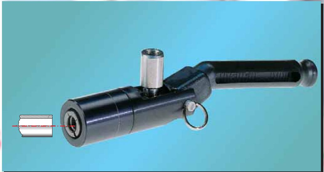
Patentierter Schnellanschluss für Druck- und Vakuumprüfungen an Glattrohren. Der Typ JXL der FasTest Serie eignet sich für Unterwasser-, Druckabfall- und Heliumtests. Er ist mit einem Sicherheitssystem ausgestattet, welches ein versehentliches Abschließen unter Druck verhindert. Die radiale Abdichtung auf dem Rohrdurchmesser arbeitet zuverlässig und überbrückt Rohrtoleranzen.
