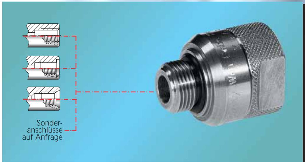
Patentierter Schnell-Schraubanschluss für Druck- und Vakuumprüfungen an Bauteilen mit Innengewinde. Der WEH-Adapter Typ MIT der FasTest Serie wird einfach handfest in den Prüfling eingeschraubt bis die Dichtung am Gegenstück anliegt. Ein Anziehen mit Werkzeugen oder Abdichten mit Dichtungsband ist nicht mehr nötig. Der Typ MIT ist als Adapter mit Mediumanschluss, mit und ohne Drehdurchführung und als Stopfen erhältlich.
