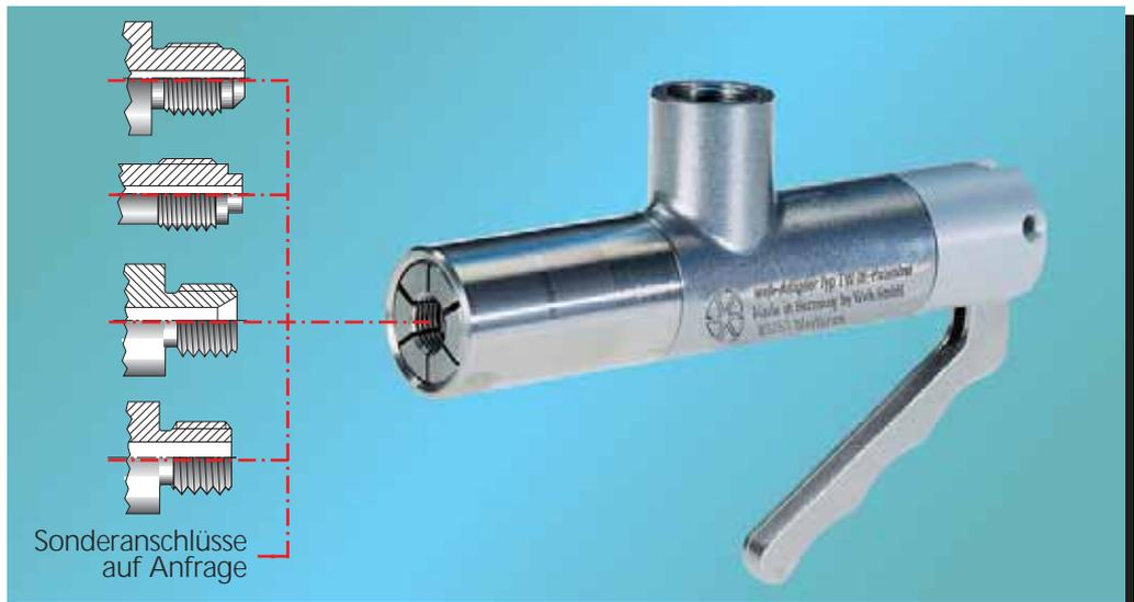
Patentierter Schnellanschluss zur hydraulischen und pneumatischen Funktions- und Druckprüfung an Bauteilen mit Außengewinde. Typ TW18 wird z. B. an Motoren, Zylindern, Druckbehältern, Schläuchen, Armaturen etc. eingesetzt. Die Spannzangen greifen im Gewinde, die druckdichte Verbindung ist hergestellt.
