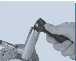
Mit der anderen Hand den Spannhebel um 90° umlegen. Typ TW19 ist nun angeschlossen.
