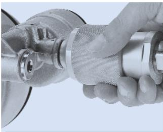
Zum Abschließen Schiebehülse zurückziehen (Ausgangsposition)
