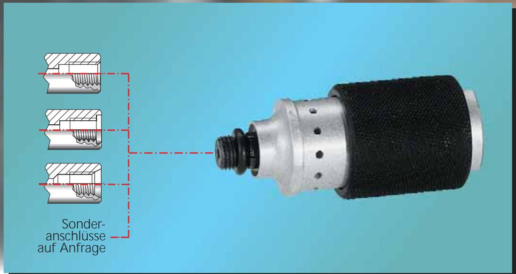
Patentierter Schnellanschluss zur Funktions- und Druckprüfung an Bauteilen mit Innengewinde in niedrigen Druckbereichen bis 12 bar. Das Anschließen und die Druckbeaufschlagung des Prüflings erfolgen in einem Arbeitsgang durch einfaches Betätigen der Schiebehülse.
