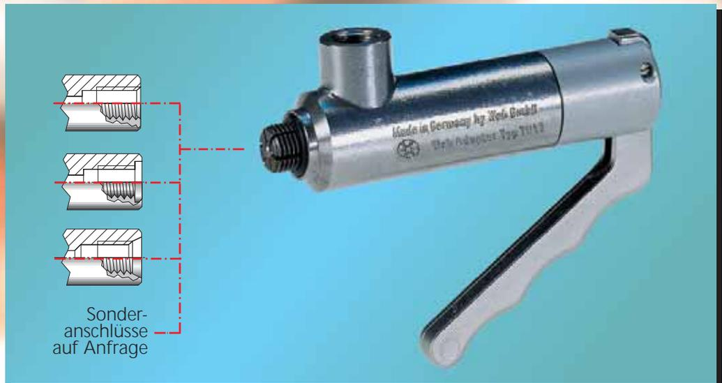
Patentierter Schnellanschluss zur hydraulischen und pneumatischen Funktions- und Druckprüfung an Bauteilen mit Innengewinde. Je höher der Prüfdruck, desto stärker spannt sich der WEH-Adapter im Gewinde des Prüflings fest und stellt so die druckdichte Verbindung in Sekundenschnelle her. Der vordere O-Ring dichtet die Verbindung sicher ab. Es werden keine zusätzlichen Spannvorrichtungen benötigt. Aufwändige und teure Prüfvorrichtungen entfallen.
