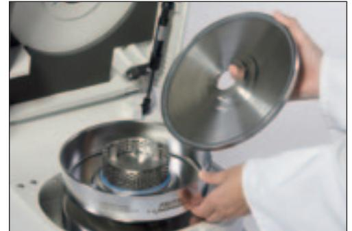
Besonders zeitsparend: **schneller Wechsel aller Mahlteile** ohne Werkzeug in wenigen Handgriffen zur einfachen Reinigung außerhalb des Gerätes.
