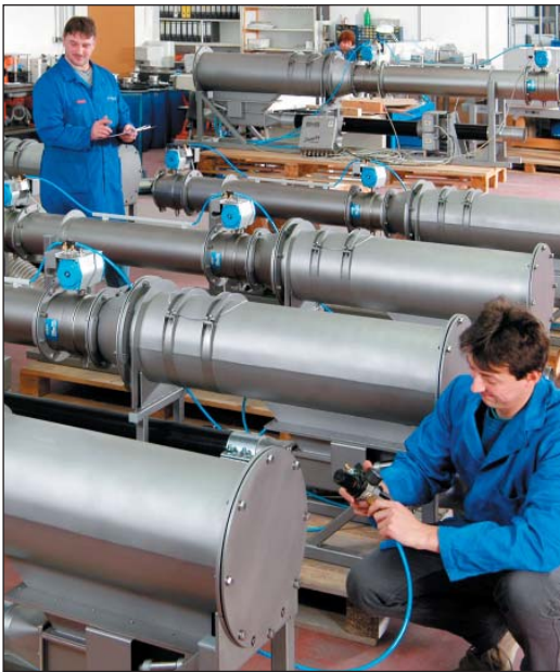
Metall-Separatoren der Serie GF 4000 eingebaut in horizontale Druck-Förderleitungen
