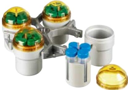
abgebildet mit Gehängen 1752 und Deckeln 1751 mit Bioabdichtung<sup>5)</sup>
