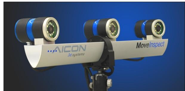
MoveInspect zur 3D Messung dynamischer Vorgänge
