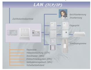
Die Einbruchmeldeanlage kann beim Verlassen/Betreten eines Gebäudes, wie bei einer Zutrittsbuchung mit dem ISGUS Sicherheitstransponder über ein IT 410 scharf/unscharf geschaltet werden.
