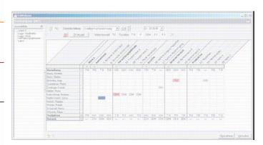
Wer wann und wo welche Tür öffnen kann, wird im "elektronischen Schließplan" hinterlegt.
