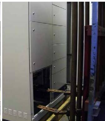
Mehr Sicherheit durch umfangreiche Prüfungen der Kurzschlußfestigkeit mit Rittal Sammelschienensystemen.
