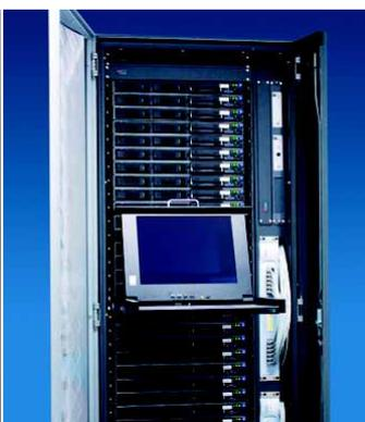
Rittal RimatriX5 – die ideale Lösung für IT-Infrastruktur mit den Komponenten: Rack, Power, Cooling, Security und Remote Monitoring.
