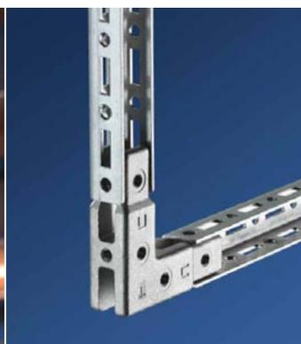
Die Anschlußstücke bieten an jeder Stelle immer einen Befestigungspunkt im 25 mm Raster, egal für welches Montageprofil.
