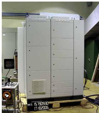
Mehr Sicherheit durch Erwärungsprüfungen mit verschiedenen Gehäuseschutzarten.
