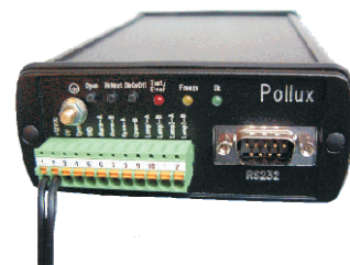
Steuergerät Pollux mit RS232-Anschluss. Pollux gibt es auch mit Netzwerk-Anschluss.
