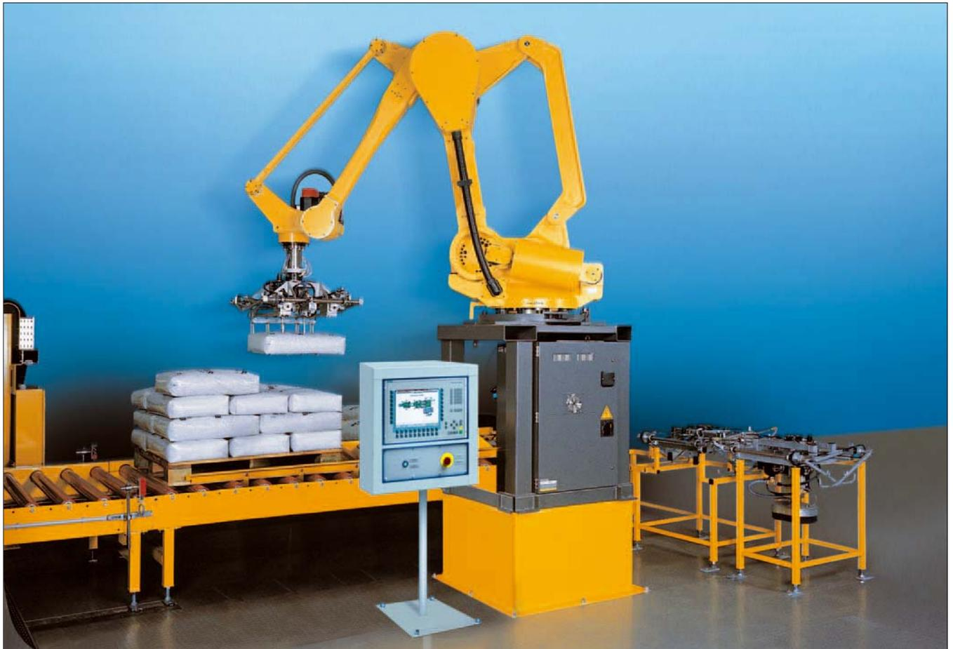
Dank seiner Flexibilität wird der BEUMER robotpac® jeder Palettieraufgabe gerecht. Robuste, erprobte Maschinenelemente in Verbindung mit elektromechanischen Antrieben gewährleisten einen sicheren Betrieb, auch in rauhem Einsatz. In staubiger Umgebung, wie sie in einer Vielzahl von Packereien auftritt, hat der BEUMER robotpac®
