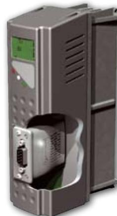
Anybus-CC-Module benutzen einen CompactFlash®-ähnlichen Stecker zur Ankopplung an die Geräteelektronik.
