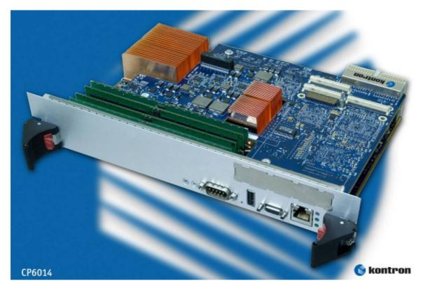
**Eching/Nürnberg, Deutschland, 26. Februar 2008 –** Das extrem leistungsfähige 6HE CompactPCI Dual-Prozessor-Board Kontron CP6014, welches Kontron heute auf der Embedded World erstmals vorstellt (Halle 12, Stand 404), bietet insgesamt acht leistungsstarke Computing Cores.
