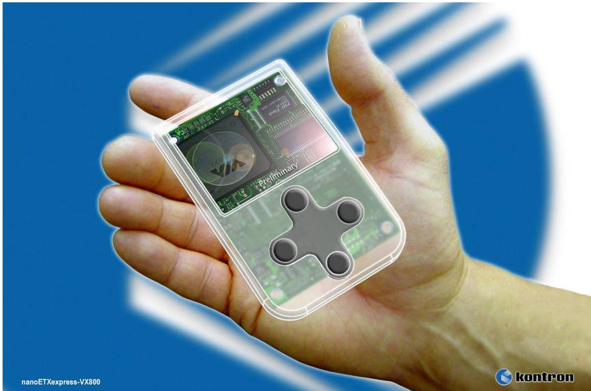
**Eching/Nürnberg, 28. November, 2007** – Kontron präsentiert auf der SPS/IPC/Drives in Nürnberg das erste nanoETXexpress® Computer-On-Module: Das nanoETXexpress-VX8 bietet auf einem Footprint von lediglich 55 mm x 84 mm energiesparende VIA Eden ULV Prozessor Performance, high-end Grafik sowie PCI Express und Serial ATA II im Scheckkartenformat.
