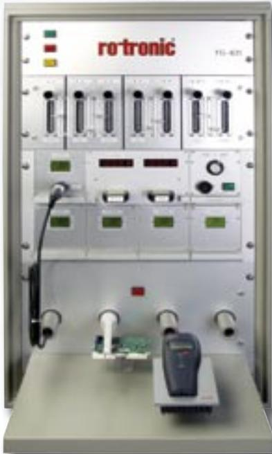
Dank dem von ROTRONIC neu entwickelten dynamischen Feuchtegenerator FG-431, eingebaut in unser Kalibriermobil, ist es erstmals möglich, rückführbare und in gewohnter ROTRONIC-Qualität erstellte Feuchte- und Temperaturkalibrationen beim Kunden vor Ort auszuführen.
