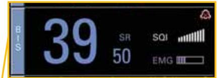
**Das BIS-Parameterfenster** zeigt den BIS-Wert sowie die zugehörigen Zahlenwerte und Balkendiagramme an. Die Anzeige lässt sich so konfigurieren, dass auch die BIS- und EMG-Trends sowie die EEG-Kurve angezeigt werden. Mit der speziellen BIS-Taste können Sie mit nur einem einzigen Tastendruck den BIS-Trend, den Sensorcheck oder das BIS-Menü aufrufen.
