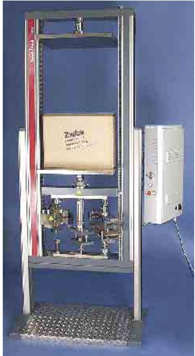
Bild 51: Die „Mc Kee-Prüfmaschine“ beinhaltet unterschiedlichste Prüfeinrichtungen speziell für die Verpackungs-/Papierprüfung
