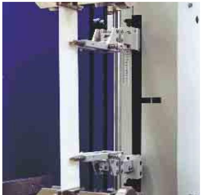
Bild 53: Mechanischer Längenänderungsaufnehmer zur hochauflösenden, direkten Wegmessung an der Probe
