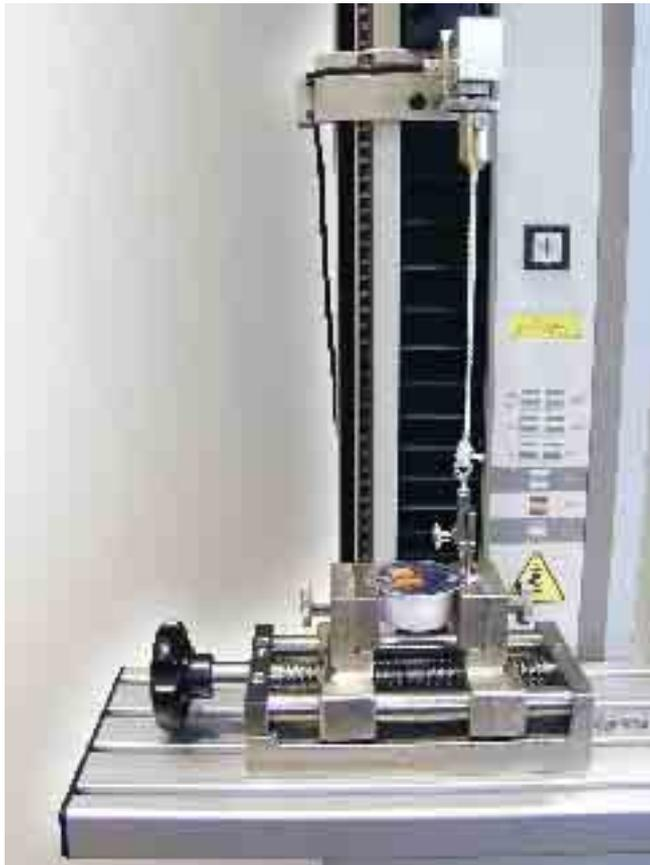
Bild 39: Abzugprüfung an einem Marmeladenbecher, der in einen Parallelschraubstock eingespannt ist. Der Abzug erfolgt mit einer kleinen Schraubklemme, befestigt an einer Schnur.
