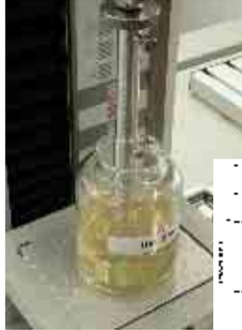
Bild 19: Bloomprüfung an Gelatine zur Ermittlung der Bloom-Härte
