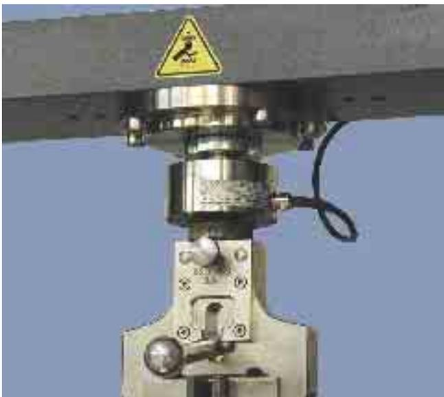
Bild 49: Ein Kraftaufnehmer aus dem umfangreichen Sortiment: Der Kraftaufnehmer vom Typ „KAF“ für Kräfte bis max. 5 kN
