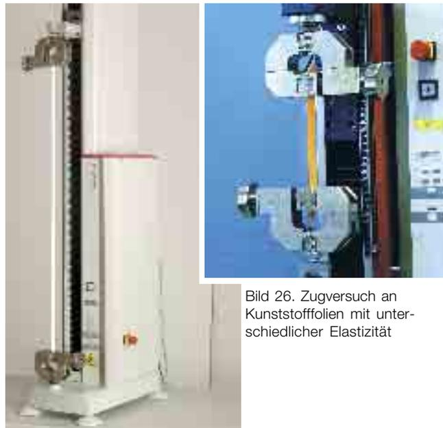
Bild 26. Zugversuch an Kunststofffolien mit unterschiedlicher Elastizität
