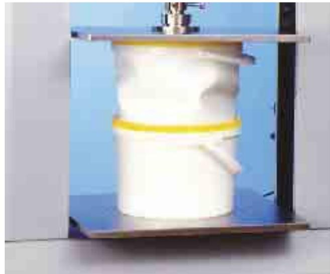
Bild 24: Stapelstauchversuch an Kunststoffeimern
