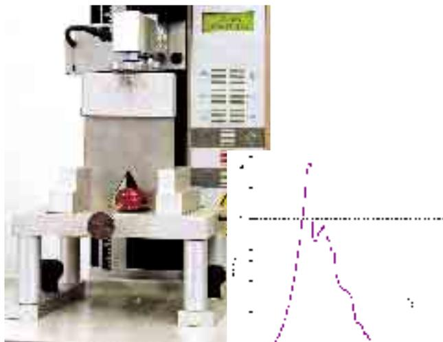
Bild 12: Warner-Bratzler Test mit gekerbter Schneide an Salami, zur Simulation des Bißverhaltens
