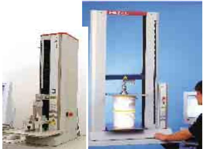
Bild 42a/b: Prüfmaschinen der BasicLine: Eine 1-säulige (links) und 2-säulige (rechts) Tischprüfmaschine
