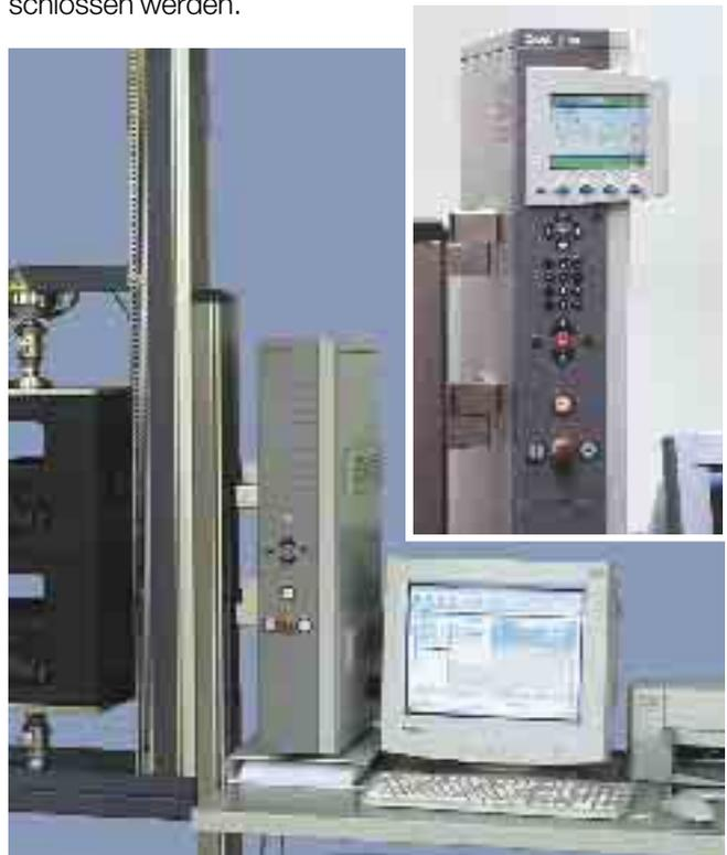
Bild 47: Das Mess-, Steuer- und Regelsystem *testControl* wird über PC bedient, oder mit Option „Stand Alone“ auch ohne PC (siehe kleines Foto)
