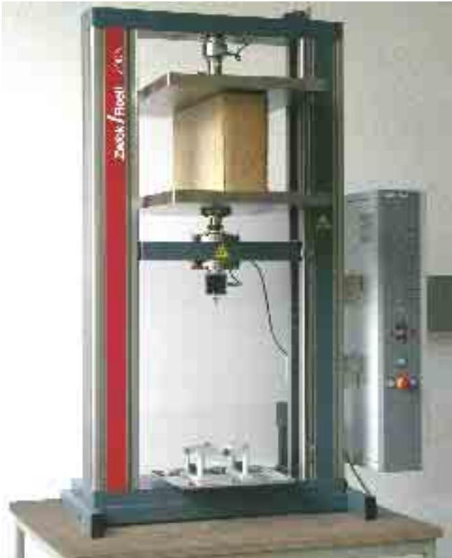
Bild 44: Durch das Einrichten mehrerer Prüfplätze in einer Prüfmaschine wird ein maximaler Nutzungsgrad bei niedrigen Kosten erreicht
