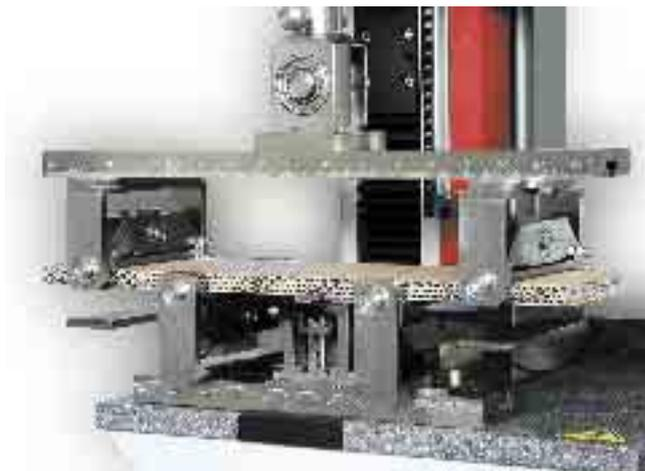
Bild 32: 4-Punkt Biegeversuch an Wellpappe
