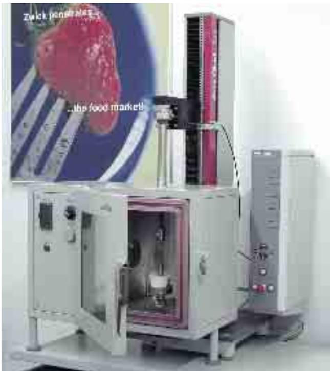
Bild 52: Eine Temperierkammer speziell für die zwicki, hier eingesetzt zur Prüfung an Lebensmitteln
