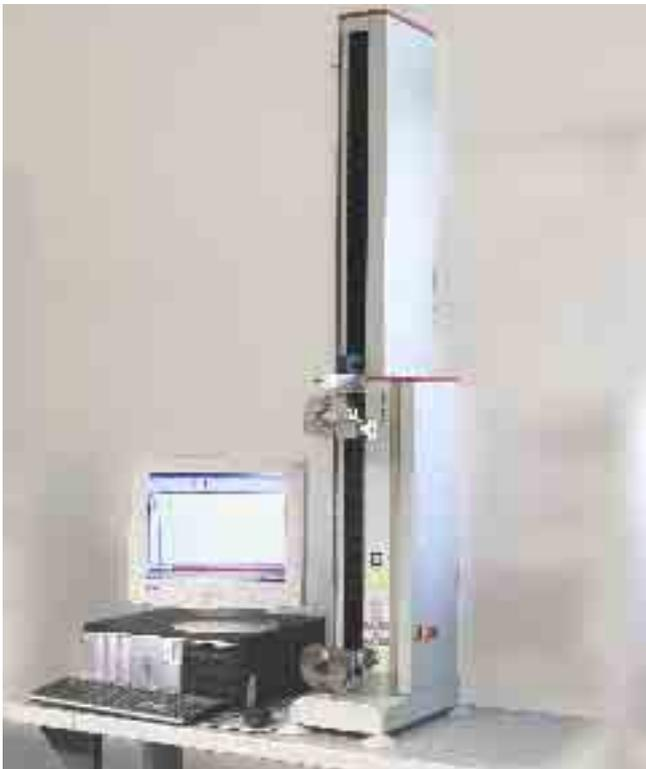
Bild 46: Das Meß-, Steuer- und Regelsystem zur BasicLine ist mit und ohne PC bedienbar
