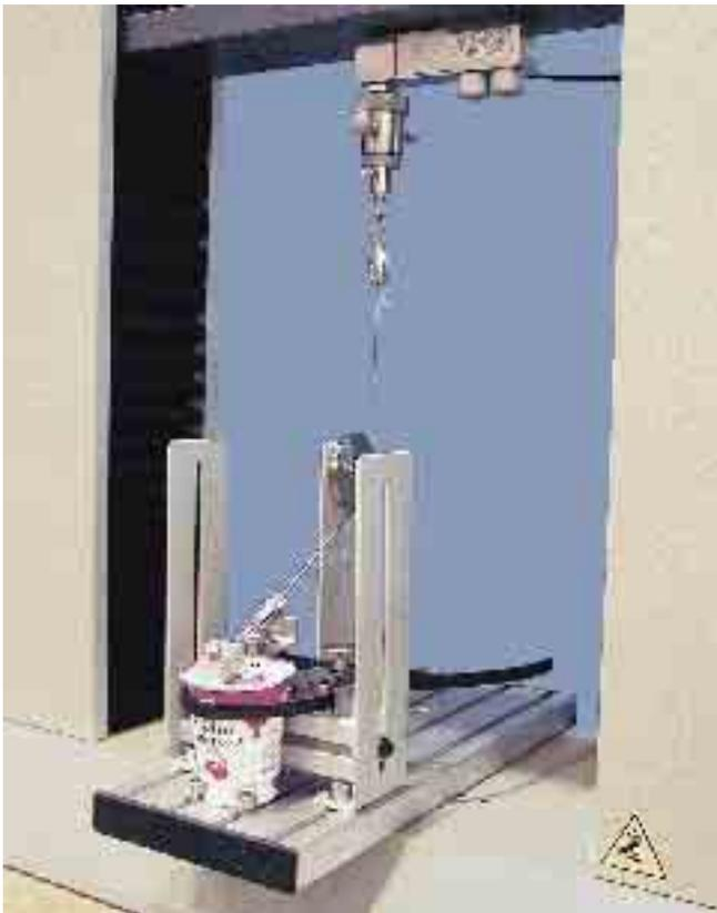
Bild 35: Abzugprüfung an Verpackungsbechern
