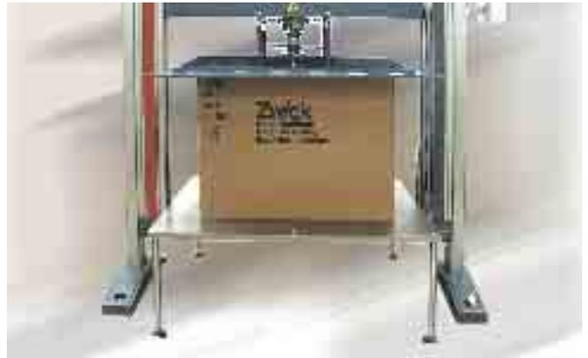
Bild 31: Schachtelstauchversuch an großen Wellpappenschachteln
