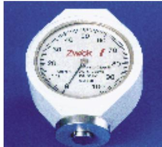
Bild 20: Wursthärteprüfung mit einem Shore A Härteprüfgerät
