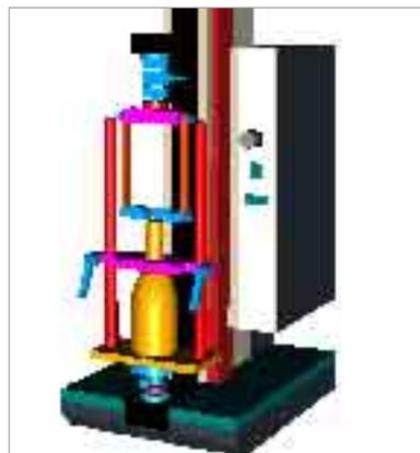
Bild 38: Graphische Darstellung des Korken-Auszugversuch an einer Weinflasche
