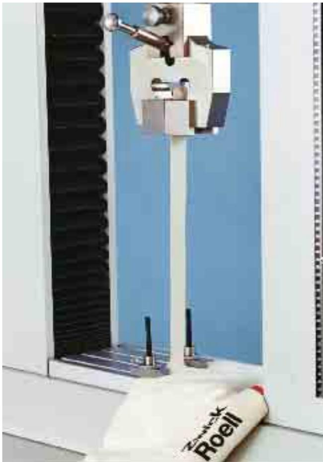
Bild 50: Eine individuell zusammengestellte Prüfanordnung: Oben ein Probenhalter, unten Elemente des BasicLine Werkzeugkastens
