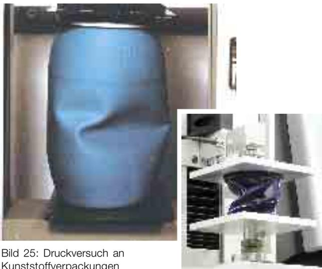
Bild 25: Druckversuch an Kunststoffverpackungen (Kunststofffaß, Joghurtbecher)
