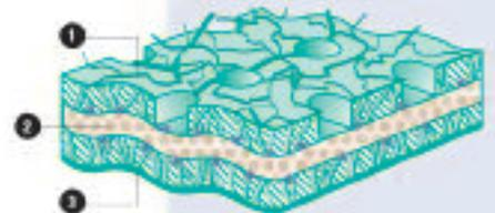
WYPALL® Reinigungstücher werden aus texturiertem, imprägniertem Polypropylen hergestellt, um anspruchsvolle Reinigungsaufgaben effizient zu erledigen.
