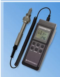
**Tragbares Drucktaupunktmessgerät HM309-DTP20/40**, zur Messung im Druckluft-Netz oder nach dem Trockner, zwei Gerätevarianten für Kältetrockner (bis  $-20^{\circ}\text{C}$  dtp) oder Adsorptionstrockner (bis  $-60^{\circ}\text{C}$  dtp), Messfühler  $\frac{1}{2}$ " mit Messkammer und Stecknippel NW7 für einfachen und schnellen Anschluss, Lieferumfang inklusive Systemkoffer
