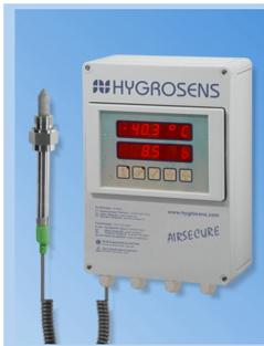
**Trockner-Regelung und Taupunktüberwachung AIRSECURE TPW-60X**, Energiekosten-optimierte Ansteuerung des Adsorptionstrockners, zusätzlich integrierte Grenzwertüberwachung mit Vor- und Hauptalarm, Anwendungsbereich  $-60^{\circ}\text{C}..+40^{\circ}\text{C}$  dtp, zweizeilige LED Anzeige, 3 potentialfreie Relaisausgänge, analoger Ausgang 0..10V (alternativ 4..20 mA), optischer/akustischer Signalgeber und Druckfühler als Option
