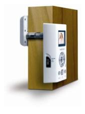
Installiert wird der IntelliCorder einfach in die vorhandene Türspionbohrung Ihrer Wohnungstür. Gespeichert werden die Aufnahmen im internen Speicher, zur Zeit 28 MB, oder auf einer optionalen SD-Speicherkarte. Die maximal verwertbare Speicherkapazität der SD-Karte ist 1 GB. Damit sind im Long-Play Modus Aufnahmen von bis zu 320 Minuten möglich.
