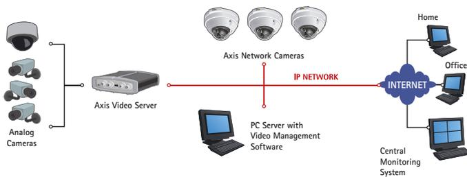
Diese Übersicht zeigt ein Beispiel der vielfältigen Analog-/Digitalkonvertierungsfunktionen der Axis Netzwerk-Videosysteme.
