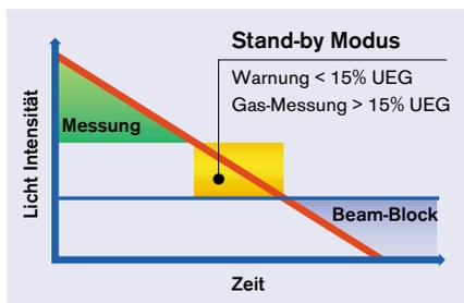
Es wird vor dem Erreichen eines Fehlers durch Verschmutzung am Analogausgang eine Warnung angezeigt. Im Hintergrund läuft die Messung weiter und bei Gaskonzentrationen oberhalb von 15% UEG wird in den normalen Messbetrieb zurückgeschaltet.
