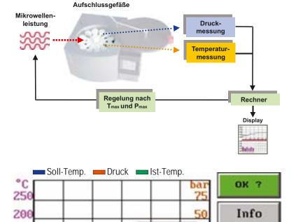
Reproduzierbare Aufschlüsse durch exakte Leistungssteuerung
