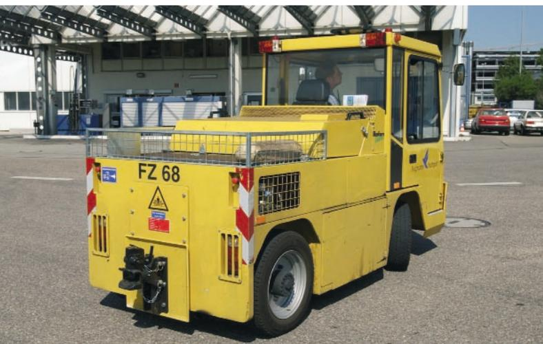
Der Rofan BatterieBooster ist eine Elektrozugmaschinen mit praktisch unbegrenzter Reichweite. Dieses Antriebssystem zeigt besonders dort seine Stärke, wo auch in geschlossenen Räumen weite Wege zurückgelegt werden müssen; bei niedriger Geschwindigkeit und geringem Stromverbrauch.
