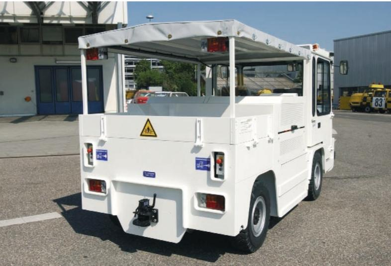
Die mit einem hydrostatischen Getriebe ausgestattete Rofan Zugmaschine vereint die Leistungskraft und Zuverlässigkeit eines Dieselantriebs mit der Wirtschaftlichkeit und Umweltfreundlichkeit eines Elektromotors.
